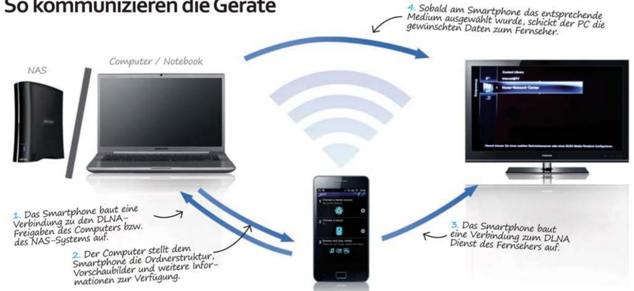
Die Kommunikation zwischen den drei Endgeräten mittels DLNA Protokoll: Die Daten (Musik, Filme, Bilder, etc.) werden am PC oder im NAS-System gespeichert, gesteuert wird über das Smartphone und abgespielt werden die gewünschten Medien am TV-Gerät.
